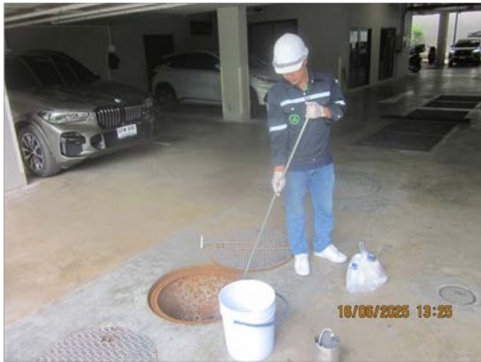
รูปที่ 3-3 การเก็บตัวอย่างคุณภาพน้ำทิ้ง บริเวณน้ำเสียก่อนเข้าระบบ (บ่อที่ 1)
